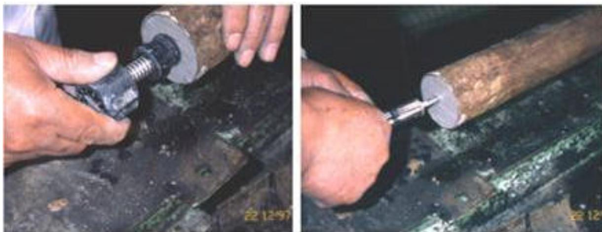
**Fotografía 5:** Ensayos de resistencia al corte con la veleta y el penetrómetro de bolsillo, realizados en la boca de un Tubo Shelby.
