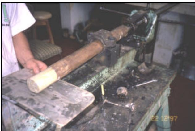
Fotografía 4: Muestra inalterada en Tubo Shelby, siendo extraída en el laboratorio.
