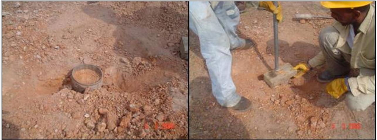
Fotografía 3: Molde metálico de CBR hincado en el fondo de un apique.
