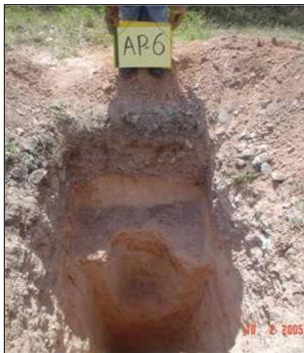
Fotografía 1: En las paredes de un apique se puede examinar directamente las condiciones de los diferentes estratos del subsuelo.
