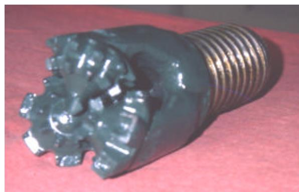
Fotografía 4: Tricono para perforar roca; no permite tomar muestras de la roca ya que la tritura.
