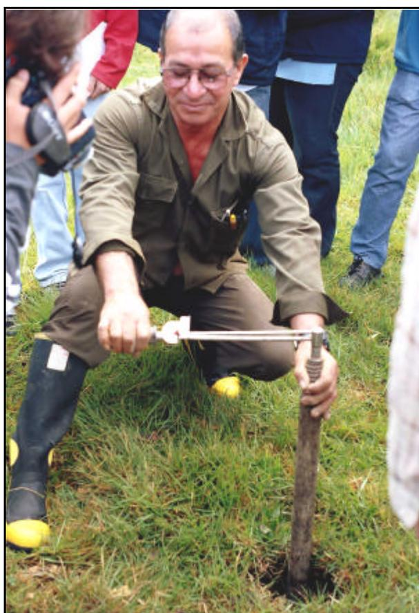
Fotografía 11: Ejecución del ensayo de veleta
