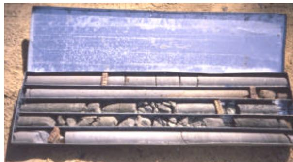
**Fotografía 5:** Los núcleos de roca recobrados se deben colocar en una caja construida de acuerdo con el diámetro de la broca.
