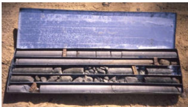
**Fotografía 10:** Disposición de los núcleos recuperados en una perforación en una caja metálica.
