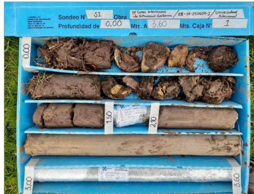
CAJA 1: Material extraído en el sondeo S1, de 0,00 m a 3,60 m.
