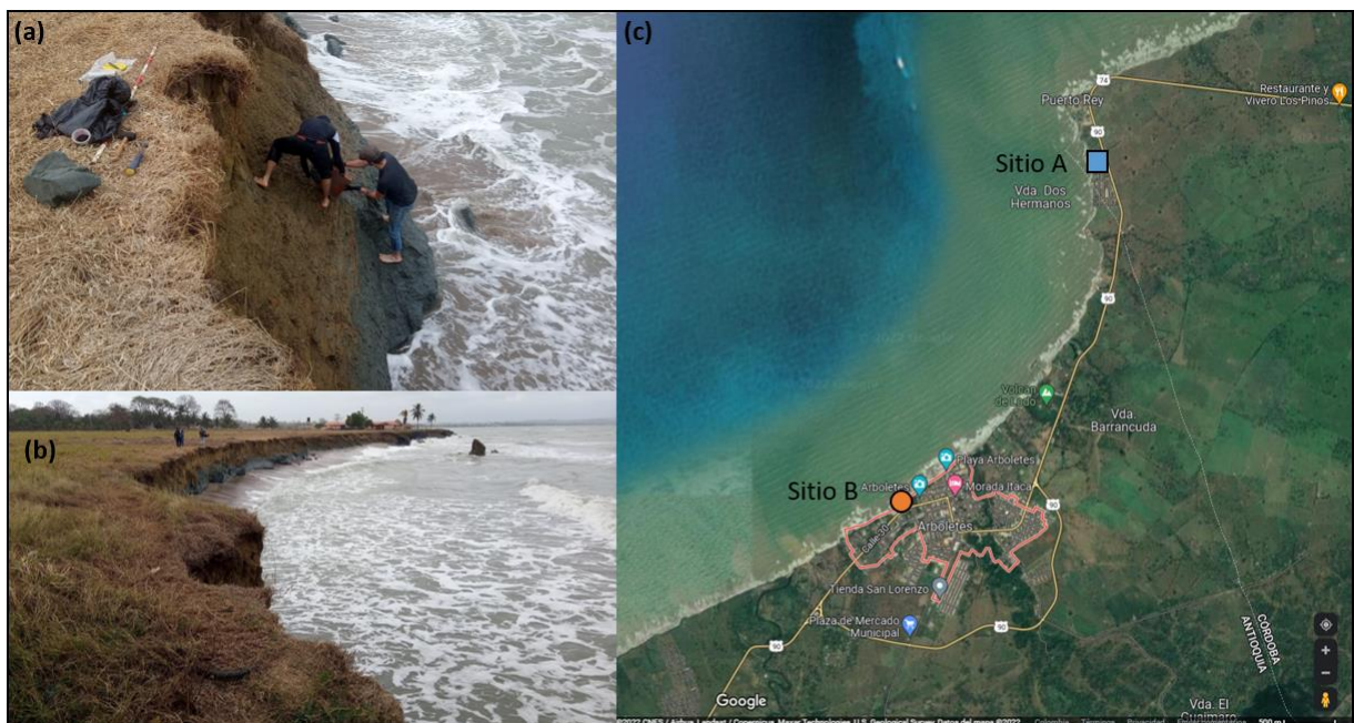
Figura 1. Bahía de Arboletes en Antioquia, Colombia: (a) Extracción de muestras de cajón sobre los acantilados, (b) fotografía Norte a Sur de los acantilados, y (c) Mapa de la bahía y ubicación de los sitios A y B. Mapa tomado de Google.
