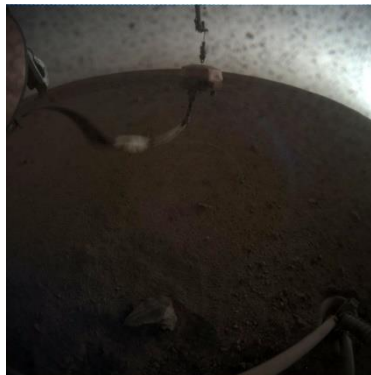
Figura 1. El instrumento SEIS durante su despliegue en la superficie de Marte, Sol 22. (Image Credit: NASA/JPL-Caltech)
