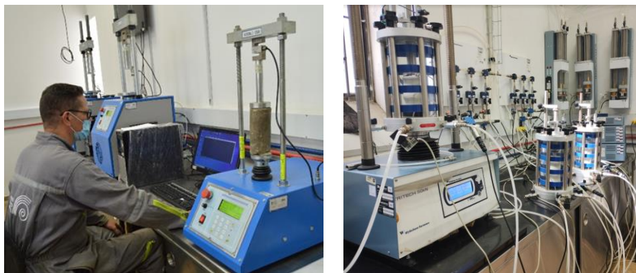
Figura 2. Ensayos de compresión inconfiada y triaxial UU en los suelos estudiados.
