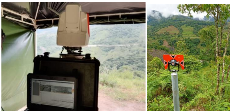
Figura 1. Ejemplo de Implementación de sistema y prismas en ladera. Fuente Geoandina i SAS.
